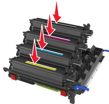
**13** Entfernen Sie den roten Verpackungstreifen vom Belichtungskit.
