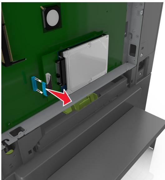
**3** Entfernen Sie die Druckerfestplatte, indem Sie sie von der Steuerungsplatine weg ziehen.
