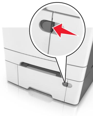
**2** Öffnen Sie die Universalzuführung.
