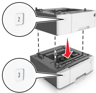
5 Richten Sie den Drucker an der 650-Blatt-Doppelzuführung aus und setzen Sie den Drucker auf die Zuführung.
