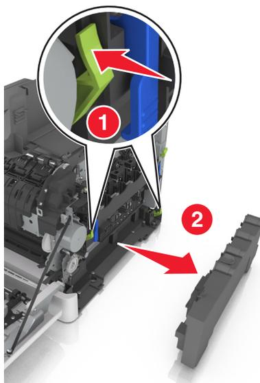
6 Klappen Sie die blauen Hebel am Belichtungskit nach oben und ziehen Sie das Belichtungskit bis zum Anschlag heraus.
