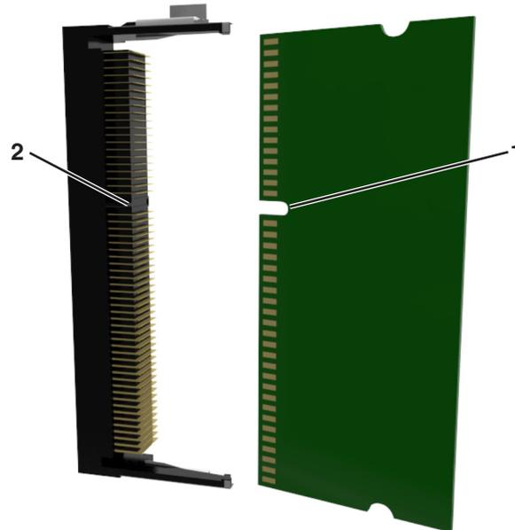
4 Schieben Sie die Speicherkarte gerade in den Steckplatz und drücken Sie die Karte in Richtung der Steuerungsplatine, bis sie hörbar einrastet.
