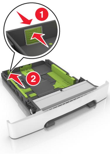
**3** Drücken Sie die Längenföhrungshebel zusammen, und schieben Sie die Föhrung in die richtige Position für das einzulegende Papierformat.
