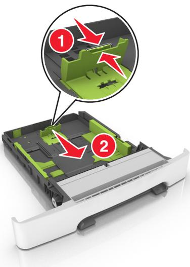
**Hinweis:** Schieben Sie die Führung mithilfe der Papierformatmarkierungen unten im Fach in die richtige Position.
