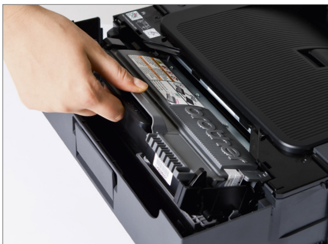
Getrenntes und leicht zu wechselndes Toner-/Trommelsystem
