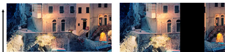
Vorlage und von ausgefallenem CIS-Modul betroffener Scan
